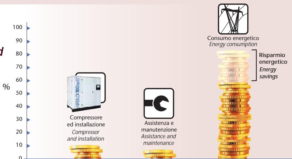
Ottenendo un consumo energetico proporzionale alla quantità d'aria richiesta (ampia regolazione d'aria prodotta che va dal 25% al 100% della portata massima) ed eliminando i picchi di assorbimento durante le fasi di avviamento mediante una rampa di accelerazione progressiva, la serie AIRBLOK SD assicura l'abbattimento dei costi energetici, in particolare in impianti con consumo d'aria fluttuante.
