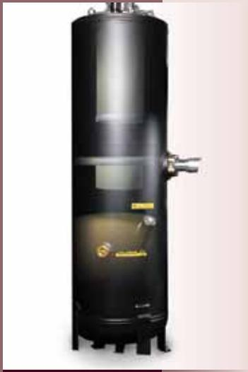
Il sistema di separazione a tre stadi è il frutto di una approfondita ricerca che ha permesso di raggiungere un'elevata qualità dell'aria in uscita. Il serbatoio disoleatore è caratterizzato da due differenti stadi di separazione: il primo di tipo centrifugo ed il secondo di tipo gravitazionale. Il terzo stadio di separazione avviene attraverso un filtro separatore a coalescenza, di lunga durata grazie anche all'efficienza dei primi due stadi, posizionato all'interno del serbatoio.
